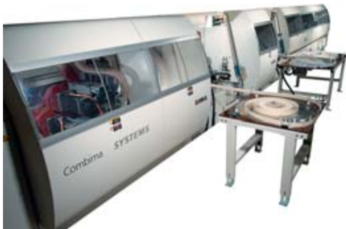
Ein wesentlicher Leistungsvorteil der Anlage besteht in der gleichzeitigen Verleimung von Stütz- und Dekorkanten in einem Durchlauf. Weiteres Highlight ist das Kopieren der Dekorkante bis zu 100 mm
