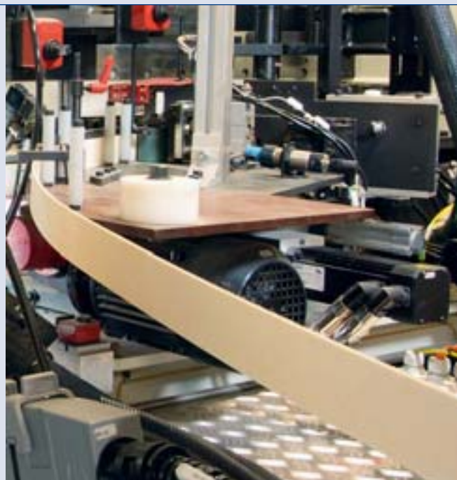
Bei Hunger wurde 2006 die europaweit erste Ima-Anlage für das Bekanten rahmenloser Wabenplatten in Betrieb genommen
